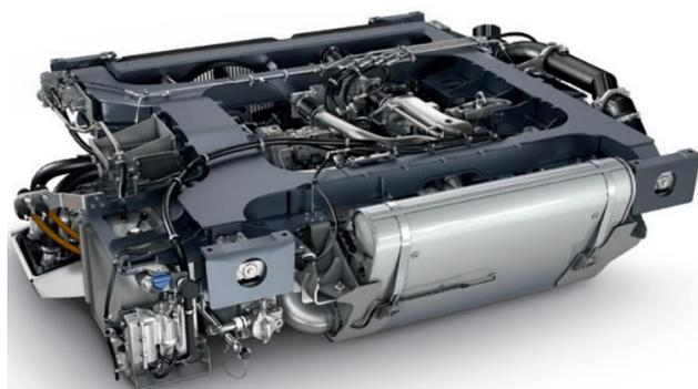
Fig. 6. MTU PowerPack 6H 1800 [23]
