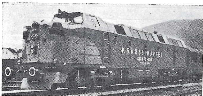
Rys. 2. Lokomotywa spalinowa f-my Krauss-Maffei 4000 KM zbudowana dla kolei amerykańskiej, wyposażona w dwa szesnastocylindrowe doładowane silniki Maybach typu MD 870, o mocy 2000 KM przy 1580 obr./min. i przekładnię hydrauliczną. Jest to w tej chwili najmocniejsza lokomotywa spalinowa.
