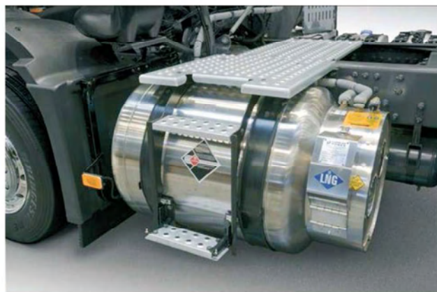
Fig. 5. Cryogenic LNG tank fitted on a truck Rys. 5. Kriogeniczny zbiornik LNG zamontowany na ciągniku siodłowym
