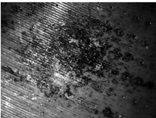
Fig. 3. Examples of deposits on external elements: fuel supplying channels of the nut (a), spray nozzle tip (b) Rys. 3. Przykłady osadów na elementach zewnętrznych: kanały doprowadzające paliwo w nakrętce (a), końcówka rozpylacza (b)
