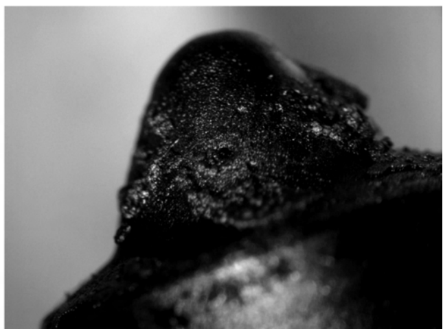
Fig. 3. Examples of deposits on external elements: fuel supplying channels of the nut (a), spray nozzle tip (b) Rys. 3. Przykłady osadów na elementach zewnętrznych: kanały doprowadzające paliwo w nakrętce (a), końcówka rozpylacza (b)
