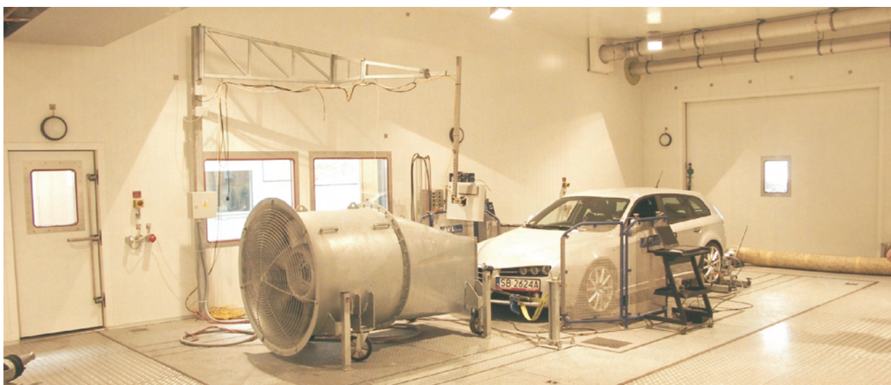
Fig. 1. Exhaust emissions laboratory at BOSMAL, showing the chassis dynamometer, windspeed fan and a vehicle, all within the climatic chamber Rys. 1. Laboratorium emisji spalin BOSMAL – hamownia podwoziowa, wentylator oraz zamontowany samochód, umieszczonych w komorze klimatycznej
