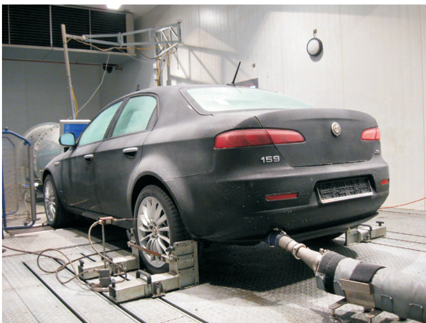
Fig. 15. Chassis dynamometer in the climatic chamber Rys. 15. Hamownia podwoziowa w komorze klimatycznej
