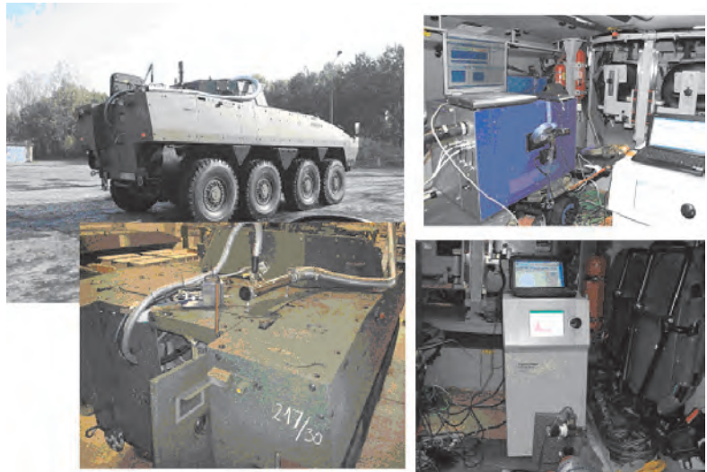
Fig. 16. Exhaust emission tests on armored vehicles under combat simulating conditions Rys. 16. Badania emisji spalin pojazdów bojowych w warunkach poligonowych
