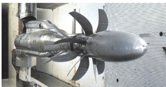
Fig. 7. The Open Rotor Concept (Rolls-Royce) Rys. 7. Koncepcja układu propfan (Rolls-Royce)
