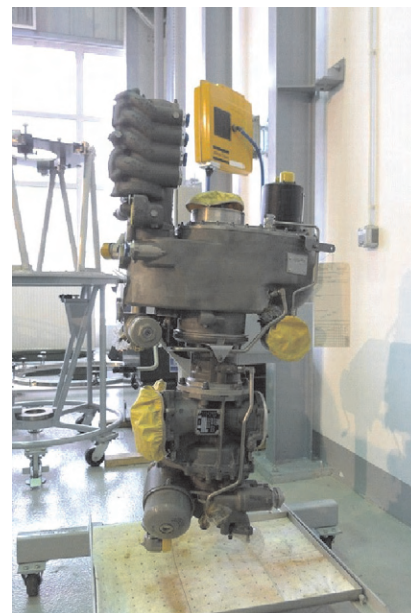
Fig. 6. Module of generator drive box (in vertical position) Rys. 6. Moduł skrzynki napędu agregatów (w pozycji pionowej)
