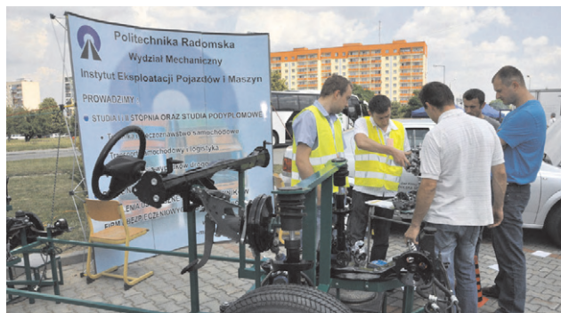
Fot. 20. Instytut Eksploatacji Pojazdów i Maszyn zaprezentował posiadane urządzenia badawcze i kontrolno-pomiarowe, m.in.: urządzenie do beztykowego pomiaru prędkości jazdy Correvit, samochód badawczy Opel Astra III, urządzenie diagnostyczne FSA 740 firmy Bosch, urządzenie do napełniania klimatyzacji firmy Bosch wraz z działającym modelem klimatyzacji samochodowej, model kompletnego zawieszenia samochodu osobowego
