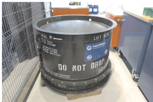
Fig. 11. Transport container for fan module
