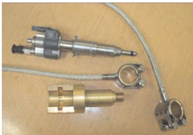
Fig. 6. The view of the gasoline injector with a heating system: a) components, b) after fitting Rys. 6. Widok wtryskiwacza benzyny z układem podgrzewania paliwa: a) elementy składowe, b) po montażu
