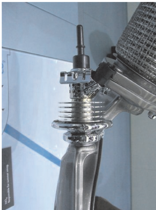
Rys. 10. Volkswagen BlueMotion – zawór wtrysku AdBlue
