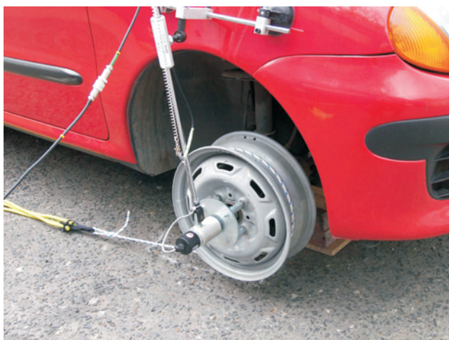
Fig. 6. View of the wheel rim with the speed sensor Rys. 6. Obręcz koła z czujnikiem prędkości obrotowej
