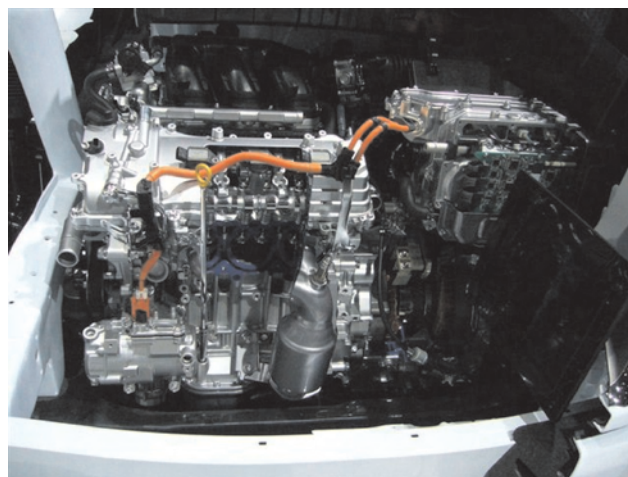
Rys. 15. Hybrydowy zespół napędowy samochodu Lexus RX 450h
