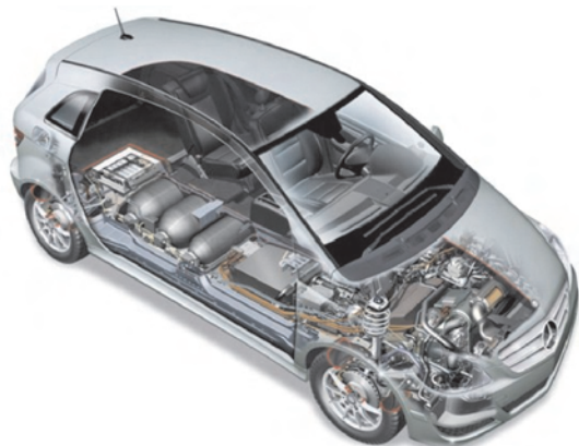
Rys. 4. Mercedes Benz klasy B F-Cell – rozmieszczenie podzespołów układu napędowego
