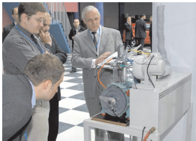
Rys. 9. Silnik modelowy napędzany alkoholem z dostępem optycznym do komory spalania
