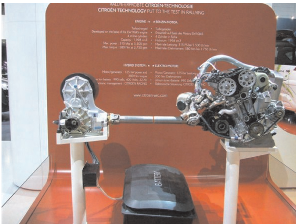
Rys. 13. Hybrydowy układ napędowy wyczynowego pojazdu Citroen C4
