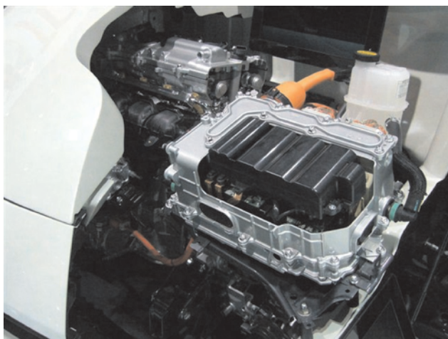
Rys. 14. Zespół napędowy samochodu Toyota Prius Plug-in Hybrid
