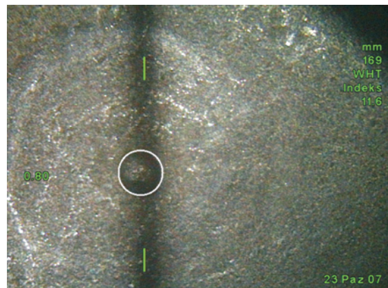
d) measurement of diameter of the bulge with a gauge – 0.80 mm, with accuracy index 11.6, which corresponds to 0.1 mm d) pomiar średnicy „wyprysku” powierzchniowego przy mierniku kołowym – 0,80 mm, przy indeksie dokładności pomiaru 11,6, co odpowiada 0,1 mm
