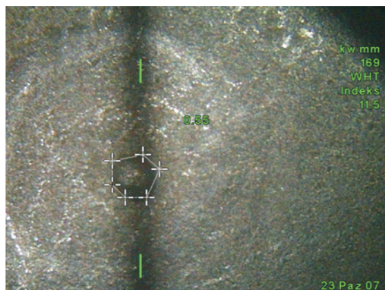
e) measurement of the area of envelope (closed broken line) of the bulge on vane surface and vane edge – 0.55 mm 2 , with accuracy index 11.5, which corresponds to 0.1 mm 2 e) pomiar pola powierzchni obwiedni (łamana zamknięta) „wyprysku” powierzchniowego w korycie łopatki i spływu łopatki – 0,55 mm 2 , przy indeksie dokładności pomiaru 11,5, co stanowi 0,1 mm 2
