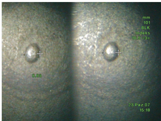
c) measurement of the diameter of the bulge on vane surface – 0.83 mm, with accuracy index 10.9, which corresponds to 0.1 mm c) pomiar średnicy „wypływu” powierzchniowego w korycie lopatki – 0,83 mm, przy indeksie dokładności pomiaru 10,9, co odpowiada 0,1 mm
