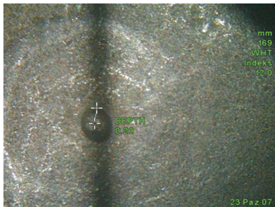
c) measurement of protrusion of the bulge on vane surface – 0.20 mm, with accuracy index 12.0, which corresponds to 0.15 mm c) pomiar wypukłości „wyprysku” powierzchniowego w korycie łopatki – 0,20 mm, przy indeksie dokładności pomiaru 12,0, co odpowiada 0,15 mm
