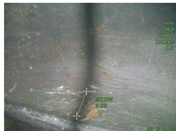
f) measurement of length of the indentation profile of the vane on the edge – 2.93 mm, with accuracy index 8.3, which corresponds to 0.1 mm f) pomiar długości profilu wgłębienia koryta łopatki przy krawędzi natarcia – 2,93 mm, przy indeksie dokładności pomiaru 8,3, co odpowiada 0,1 mm
