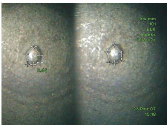
e) measurement of the area of the envelope (closed broken line) of the bulge on vane surface – 0.45 mm 2 , with accuracy index 10.8, which corresponds to 0.1 mm 2 e) pomiar pola powierzchni obwiedni (zamknięta) „wypływu” powierzchniowego w korycie lopatki – 0,45 mm 2 , przy indeksie dokładności pomiaru 10,8, co odpowiada 0,1 mm 2
