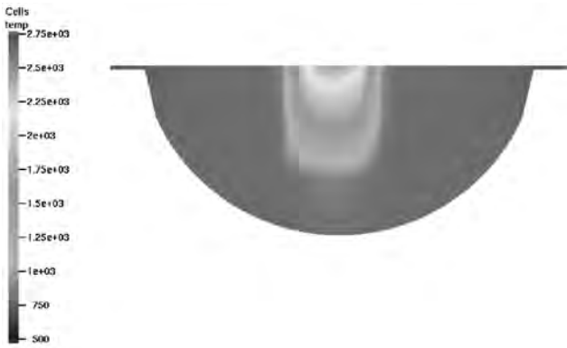
Fig. 3. Temperature distribution for central spark plug at \lambda = 1.2 and TDC Rys. 3. Rozkład temperatury dla świecy centralnej w ZZP dla \lambda = 1,2
