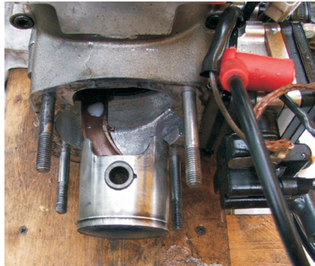
Rys. 11. Przykłady uszkodzeń układu korbowo-tokowego: a) szlifowanie zatartego cylindra, b) zgięcie korbowodu Fig. 11. Examples of damage to the assembly of crankshaft, pistons and connecting rods: a) grinding of the seized cylinder, b) bending of connecting rods
