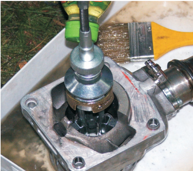
Rys. 11. Przykłady uszkodzeń układu korbowo-tokowego: a) szlifowanie zatartego cylindra, b) zgięcie korbowodu Fig. 11. Examples of damage to the assembly of crankshaft, pistons and connecting rods: a) grinding of the seized cylinder, b) bending of connecting rods
