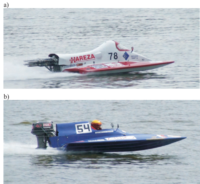
Rys. 1. Przykładowe klasy i serie motorowodne: a) seria „O” – łodzie wyścigowe typu katamaran z silnikami przyczepnym, silniki nieseryjne, dopuszczalne własne konstrukcje, b) seria „T” – łodzie jednokadłubowe typu „V” z silnikiem przyczepnym, silnik seryjny, przeróbki niedopuszczalne
