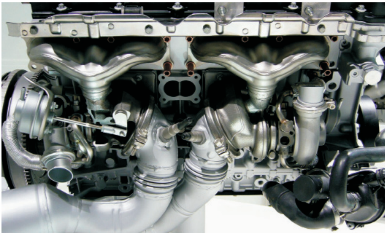
Rys. 2. System doładowania silnika BMW 3,0 dm 3 Twin Turbo [zdj. autora]
