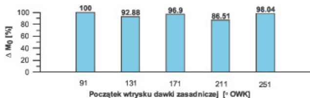
Rys. 26. Procentowe zmiany momentu obrotowego silnika w zależności od początku wtrysku (n = 1500 obr/min, wtrysk podwójny, czas wtrysku 2x3,4 ms)
