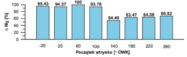
Rys. 24. Procentowe zmiany momentu obrotowego silnika w zależności od początku wtrysku (n = 1500 obr/min, wtrysk pojedynczy, czas wtrysku 4,4 ms)
