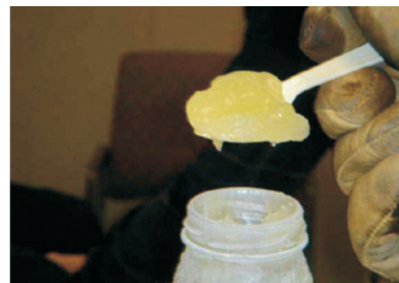
Rys. 14. Galaretowaty charakter biopaliwa w niskich temperaturach
