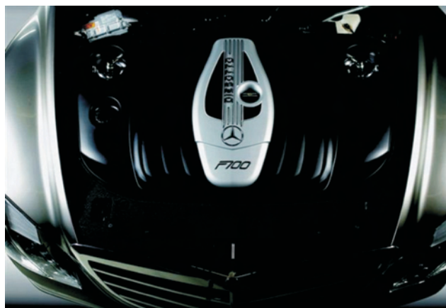
Rys. 4. Silnik DiesOtto zabudowany w koncepcyjnym samochodzie Mercedes Benz F700
