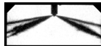
Rys. 1. Stanowisko do badań optycznych strugi wtryskiwanego paliwa oraz przykład zarejestrowanego obrazu
