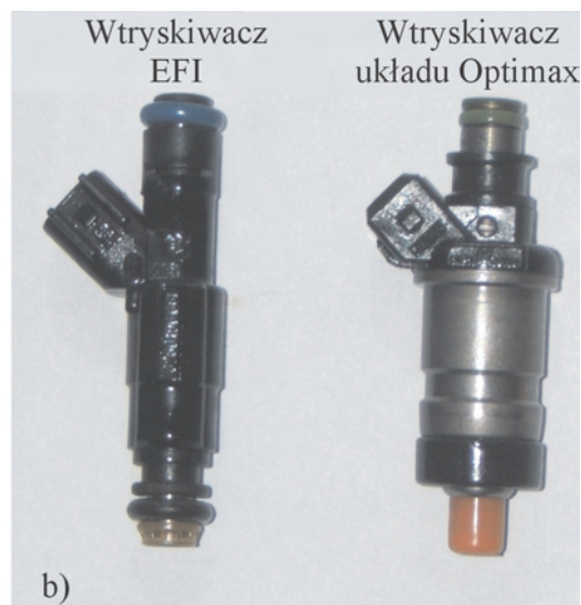
Rys. 17. Budowa wtryskiwacza układu wtryskowego EFI (a) oraz porównanie wtryskiwaczy typu EFI i (b) wtryskiwacz z układu Optimax: a) zawór iglicowy, b) dysza, c) końcówka wtryskiwacza, d), g), m), s) O-Ring, e) nasadka zaworu iglicowego, f) rdzeń, h) sprężyna, i) obudowa, j) uzwojenie cewki, k) taśma, l) szpul, n) pierścień wewnętrzny, o) nakładka, p) przyłącze, q) wtyczka, r) filtr
