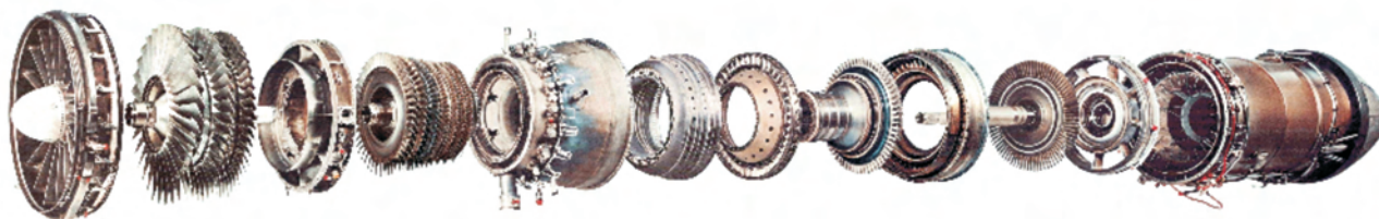
Rys. 25. Modułowa budowa silnika turbinowego F404-GE-400 Fig. 25. Modular design of the turbofan F404-GE-400
