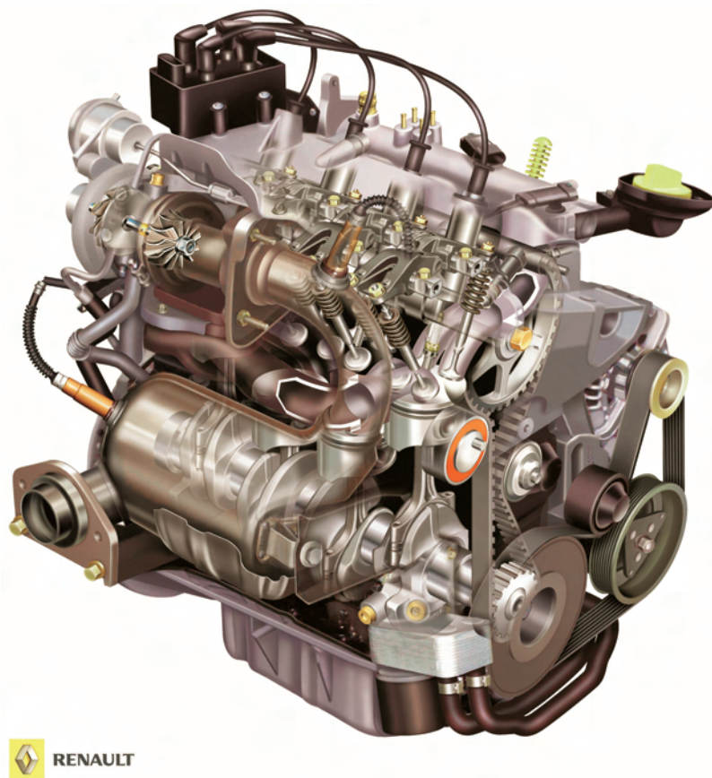
Rys. 3. Przekrój silnika TCE 100 firm Renault i Nissan
