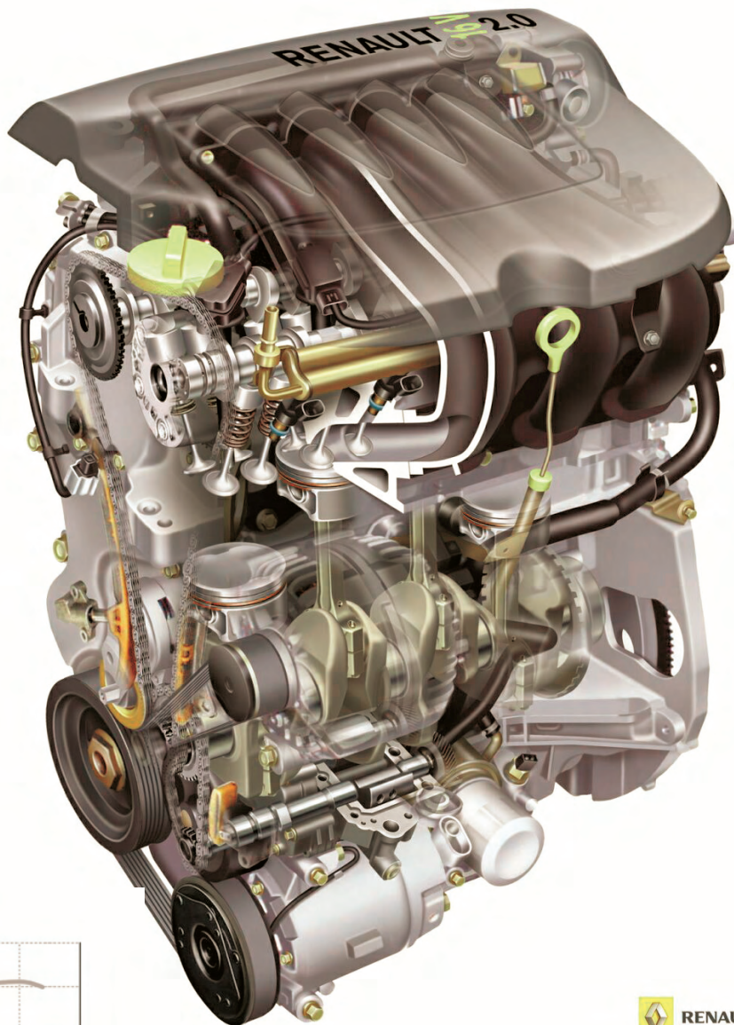
Rys. 1. Przekrój silnika M4R firm Renault i Nissan
