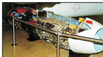
Rys. 15. Turbinowy silnik odrzutowy Jumo 004B
