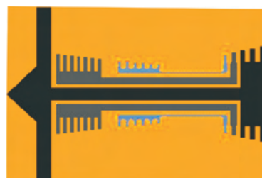
Rys. 27. Schemat układu wirników dwuprzepływowego silnika turbinowego RB211-535
