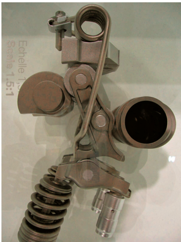
Rys. 18. Układ zmiany skoku zaworu BMW Valvetronic
