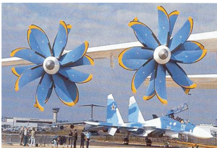
Rys. 23. Łopaty „śmigłowentylatorów” samolotu An-70 Fig. 23. Propfan propellers on the aircraft An-70
