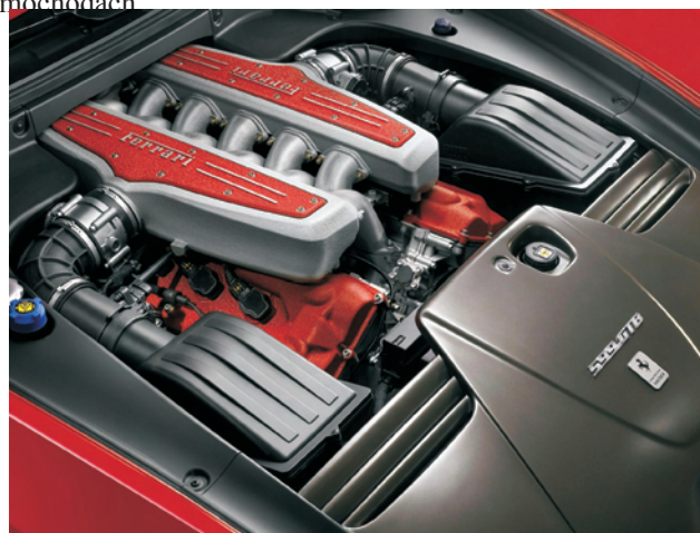
Rys. 4. Silnik V12 6,0 dm 3 samochodu Ferrari 599 GTB Fiorano
