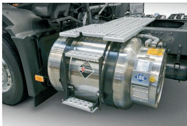
Fig. 5. Cryogenic LNG tank fitted on a truck
