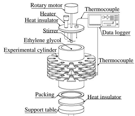
Fig. 3. Experimental apparatus
